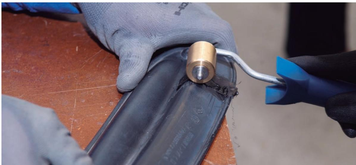
El proceso de trabajo recomendado con el equipo Plastic Welder System, para la reparación de una fisura o rotura en un material termoplástico consiste en:
