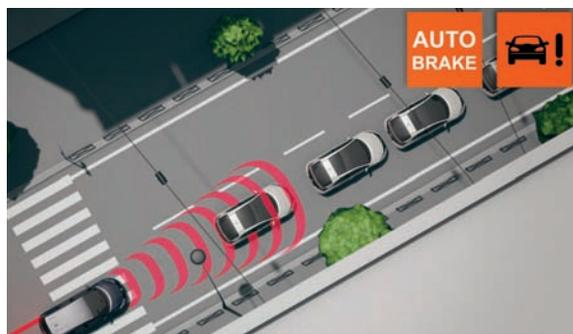
*Sistema de frenado de emergencia autónomo.*
