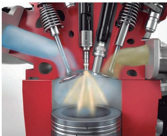
Mediante el Downsizing y la turbocarga la inyección directa de gasolina reduce el consumo y, con ello, las emisiones de CO<sub>2</sub> hasta en un 15 por ciento. En combinación con el Downsizing, la turbocompresión y el Scavenging, la inyección directa de gasolina brilla con una mejor respuesta y una mejor dinámica de conducción gracias al aumento del par motor de hasta el 50 por ciento. *Agradecimiento a Bosch.* ☉
