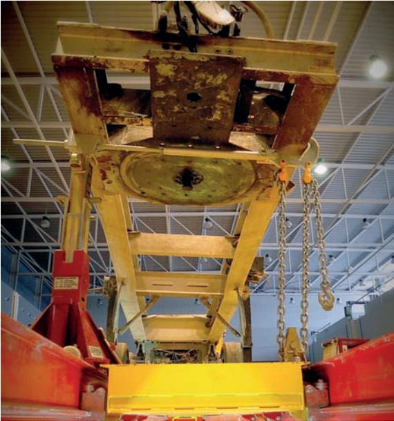
A diferencia que la bancada de reparación de cabinas, este tipo de bancada no dispone de plantillas ni de fichas de reparación. Esto no es un inconveniente para poder llevar a cabo una reparación óptima y de precisión puesto que se disponen, generalmente, de sistemas de medición ópticos por láser, capaces de verificar la correcta posición y alineación de largueros y travesaños del vehículo.
