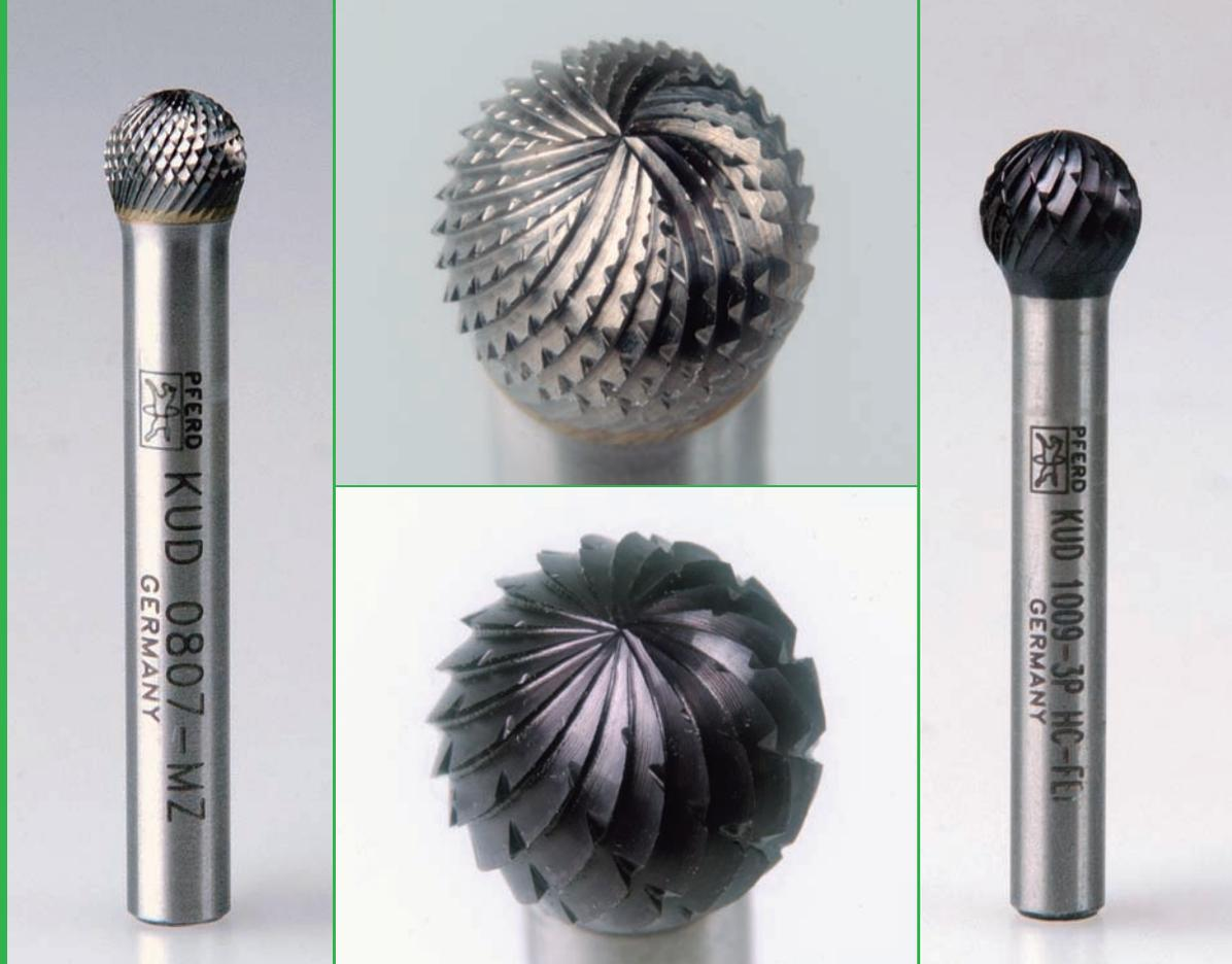
Así mismo, también está disponible para este material, la fresa esférica **Pferd** de metal duro con dentado MZ (microfresa), cuyo dentado fino, permite un mecanizado con un arranque de virutas fino y con menos proyecciones en este tipo de piezas.
